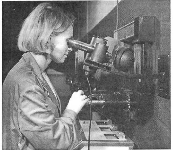
Pomiar gęstości optycznej z zastosowaniem odpowiedniej głowicy z kulą Ulbrichta
