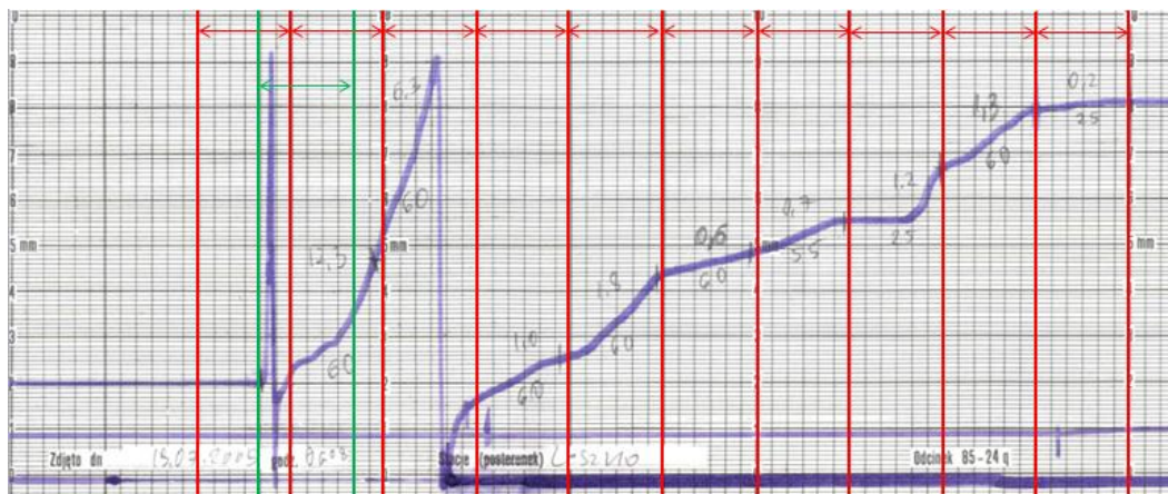
Rys. 4.4. Porównanie metody odczytywania przedziałowych wysokości opadów dla t = 60 min, linia czerwona oznacza sztywne przedziały godzinowe, linia zielona ruchomy przedział t = 60 min
