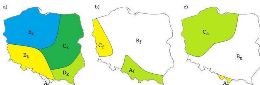
Rys. 2.11. Regiony opadów maksymalnych z uwzględnieniem genezy powstawania opadu: a) konwekcyjny; b) frontalny; c) niżowy. Opracowano na podstawie [Suligowski 2004]
