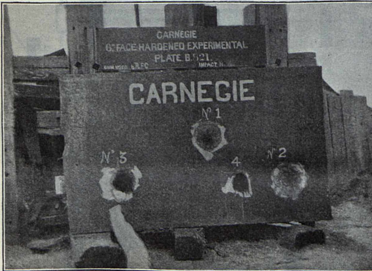
Beschussprobe einer Carnegie-Panzerplatte.
