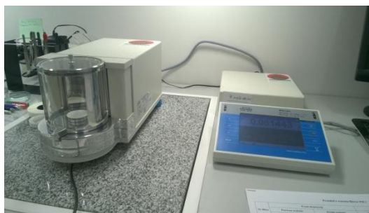
Rysunek 6.15. Waga Xa 60/220 firmy RADWAG w pokoju wagowym WIOŚ w Poznaniu (obecnie CLB GIOŚ) (autor: Anna Chlebowska-Styś)
