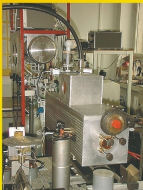
Lasery CO 2 wzbudzany prądem w.c.z. mocy 200W.
