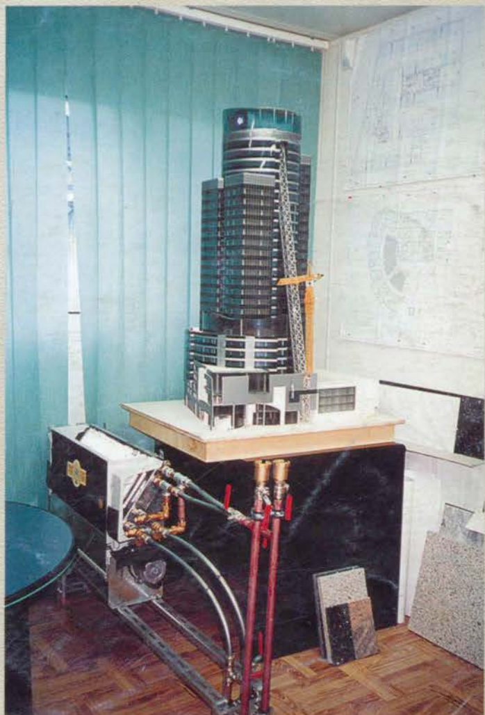
Model wieżowca TP S.A. w Warszawie. Widoczne pneumatyczne zasilanie jego ruchomych części.
