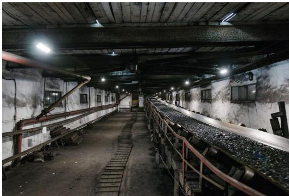
Rys.4.11. Przykładowy podajnik węgla z kopalni Dobropolska, obwód Doniecki, Ukraina. (Źródło: https://metallurgprom.org/uk )
