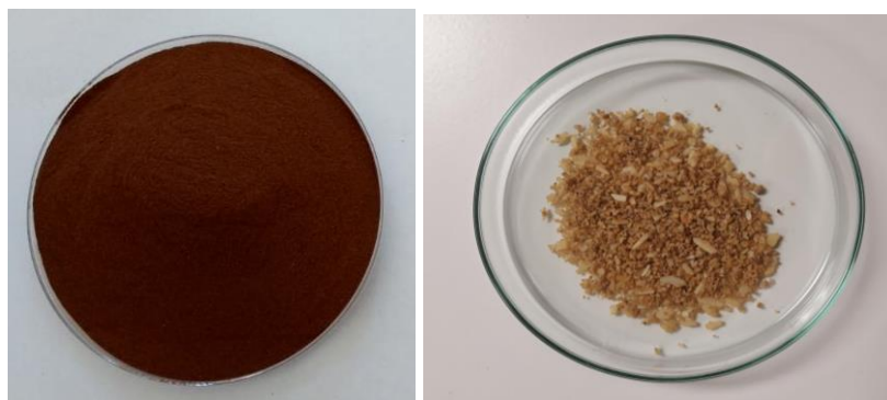
Rys. 4. Wtórne surowce fosforowe wykorzystane do badań (od lewej: popiół ze spalania osadów ściekowych, rozdrobnione kości indyka)
