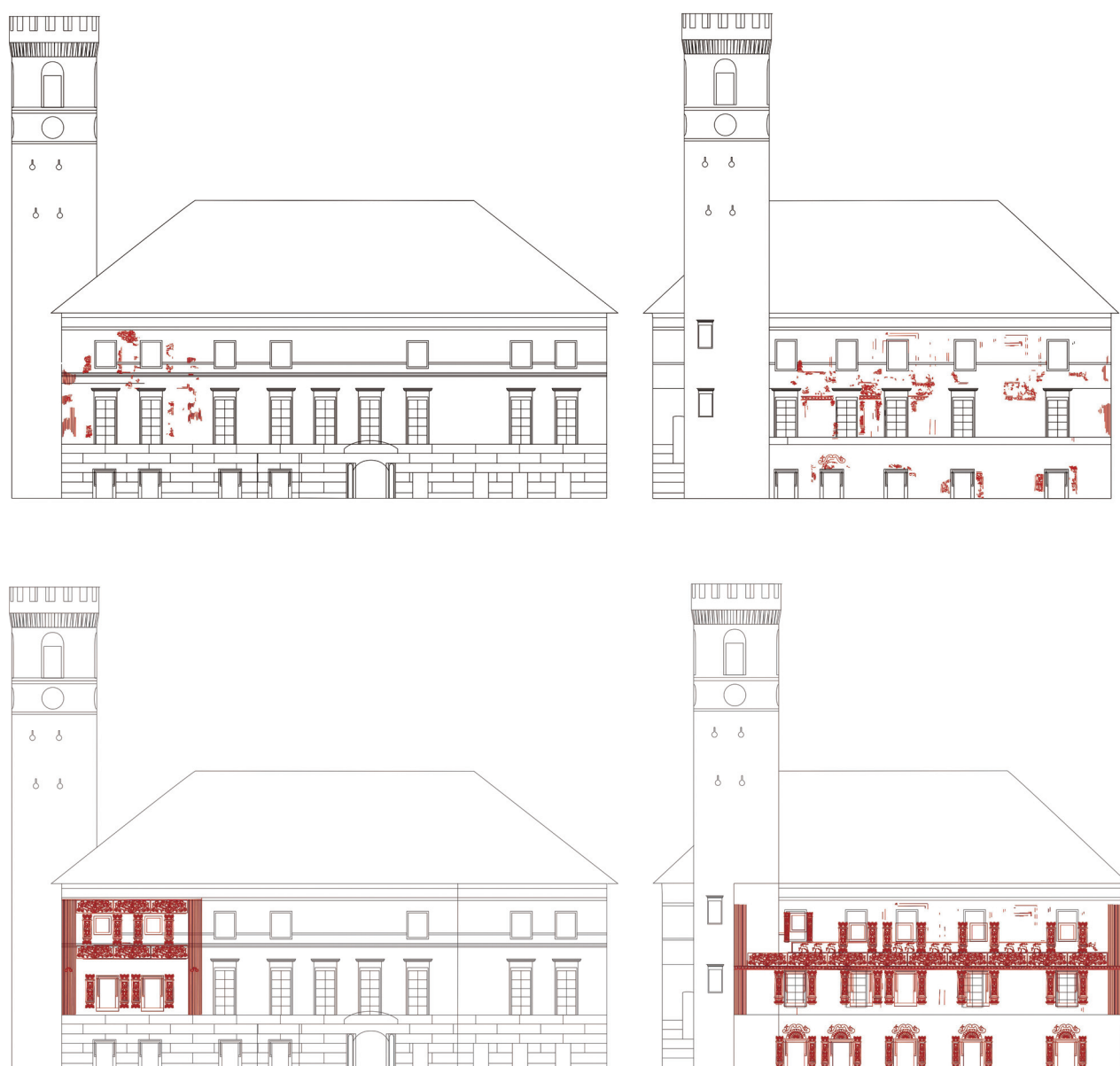
Il. 3. Elewacja południowa i wschodnia – inwentaryzacja i częściowa rekonstrukcja dekoracji sgraffitowej oraz podziałów architektonicznych w fazie renesansowej (oprac. M. Pszczółkowski)
