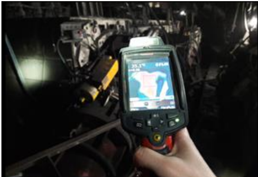
Rys. 1. Kamera termowizyjna Flir i60 na tle badanego układu napędowego
