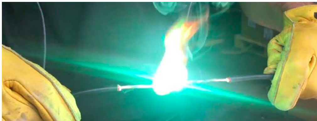
Rys. 3. Łuk elektryczny wywołany na instalacji fotowoltaicznej o mocy 1 kWp [2]
