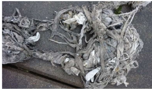
Rys. 3.5 Typowy zlepek szmat "gałgan" usunięty z pompy. Źródło: strony WWW.
