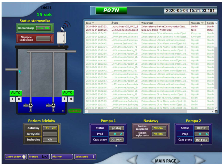
Rys. 3. Przykładowe zdjęcie ekranu obrazujące widok panelu sterującego SCADA.
