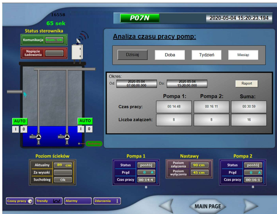
Rys. 2. Przykładowe zdjęcie ekranu obrazujące widok panelu sterującego SCADA.
