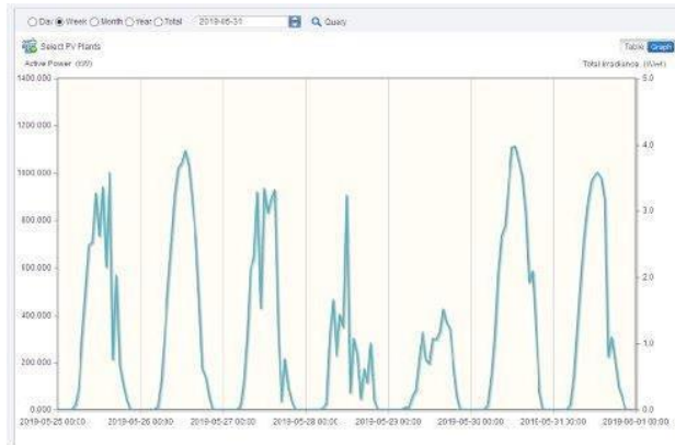
Rys. 25. Otrzymane dane z instalacji fotowoltaicznej 1500 [kW] z ostatniego tygodnia miesiąca maj od 25.05 do 01.06 [2].
