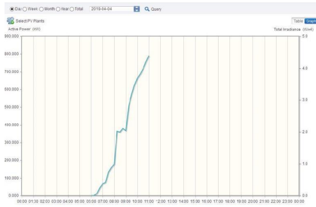
Rys. 31 Otrzymane dane z instalacji fotowoltaicznej 1500 [kW] z pojedynczego dnia miesiąca kwiecień 2019 roku w trakcie awarii serwera [2].
