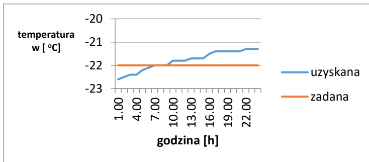
Rys. 3. Spadek temperatury kiedy nie pracowały sprężarki amoniakalne przy temperaturze zewnętrznej 29° [2].
