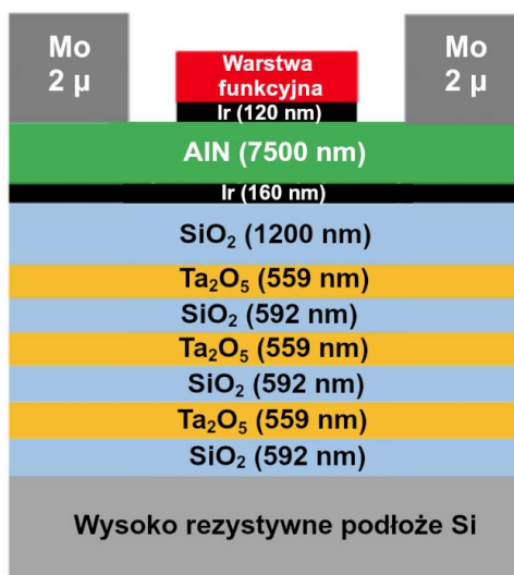
Rysunek 4.2. Sensor BAW typu SMR wykorzystujący warstwę AlN do aktywności piezoelektrycznej oraz układ warstw SiO 2 , Ta 2 O 5 (na podstawie [77]).
