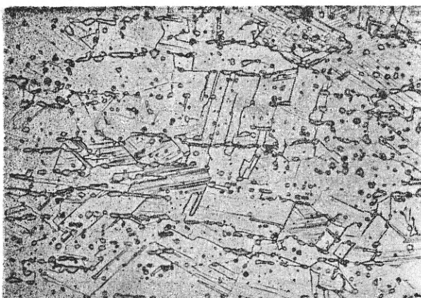
Rys. 3. Stal jak na rys. 2, polerowana elektrolitycznie i trawiona elektrolitycznie w 0,5% roztworze wodnym kwasu szczawowego \times 380
