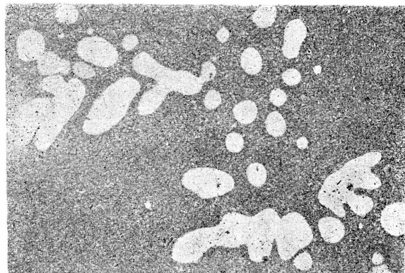
Rys. 8. Mikrostruktura próbki żuźła nr 32548/2 V=1,95
