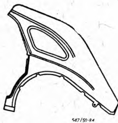
Rys. 4. Przedmiot wykonany z dwóch tłoczonych części połączonych przez spawanie.
