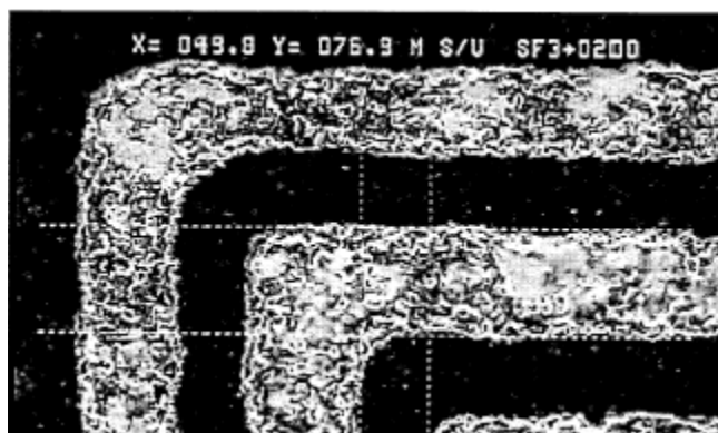
Rys. 5.1. Zdjęcie ścieżek przewodzących Ag wykonanych za pomocą sitodruku precyzyjnego (szerokość ścieżek 75 \mu\text{m} ) [7]
