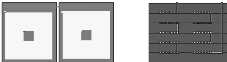
Rys. 5.37. Geometria cewki i przekrój przez strukturę LTCC [88]
