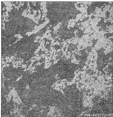
Rys. 1. Mikrostruktura materiału ciernego metalowo-ceramicznego (x200).
