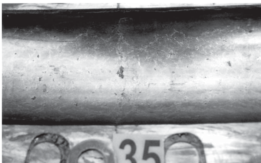
Rys. 10.14. Powierzchnia bieźni dolnej – punkt 35 – łożysko 100
