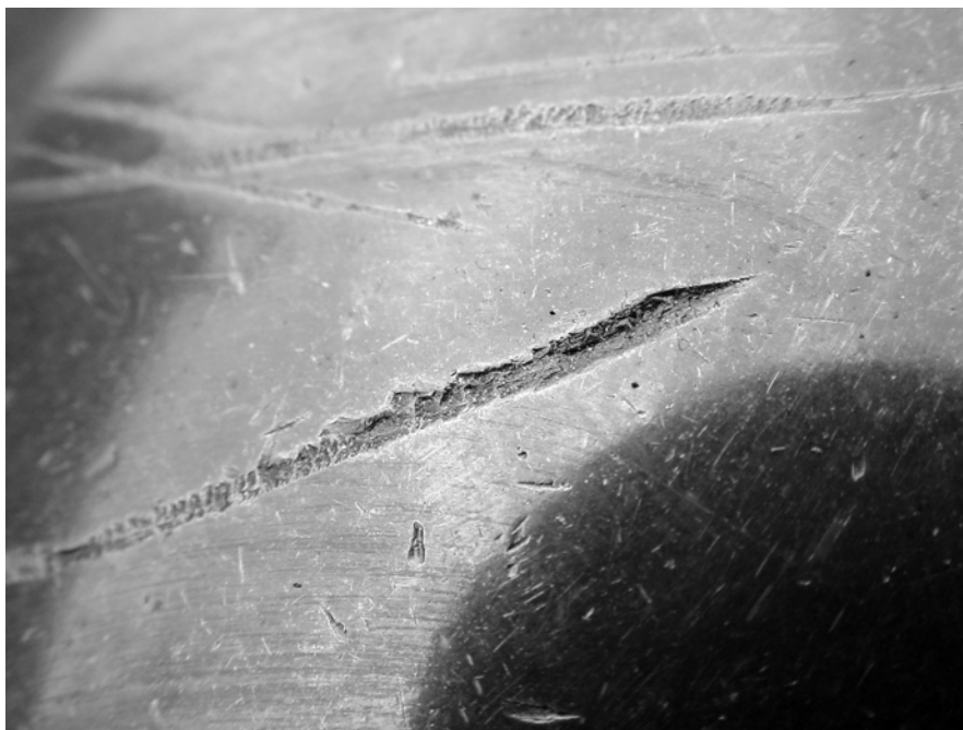
Rys. 10.55. Uszkodzona powierzchnia elementu tocznego
