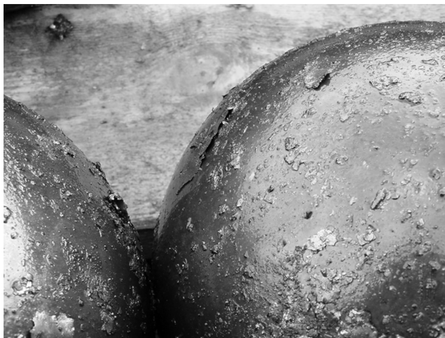
Rys. 10.54. Produkty pitingu bieżni na elementach tocznych
