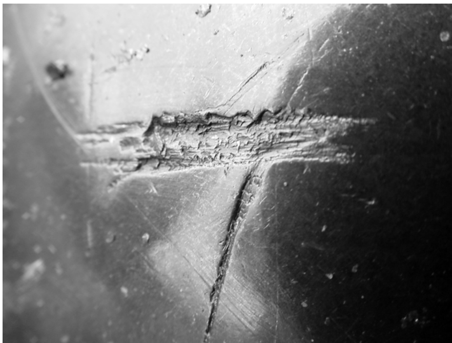
Rys. 10.56. Uszkodzona powierzchnia elementu tocznego
