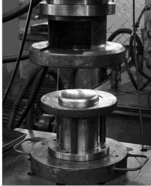
Fig. 10. A test stamping die
