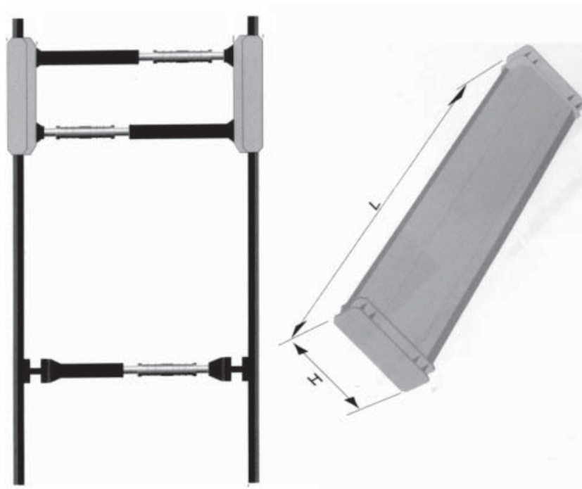
Rys. 4.1.2. Zabezpieczenie wykopu systemowymi podłużnicami i regulowanymi rozpórkami firmy SBH
