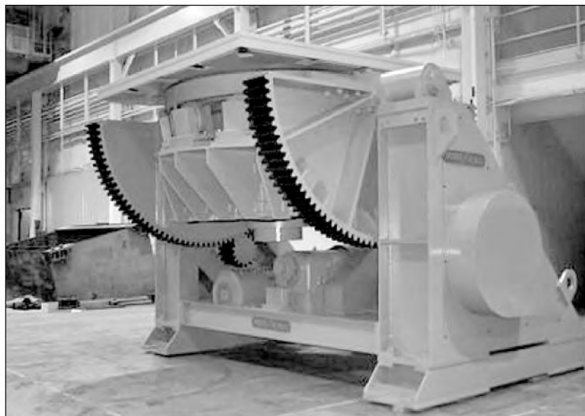
Зразки маніпуляторів для зварювання великогабаритних вузлів
