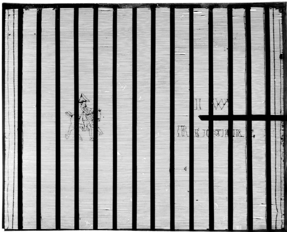
32. Duszniki – Papiernia – Forma czerpalna. Fot. K. Gawinowska, X. 1960 r. Neg. P.K.Z. – Wrocław
