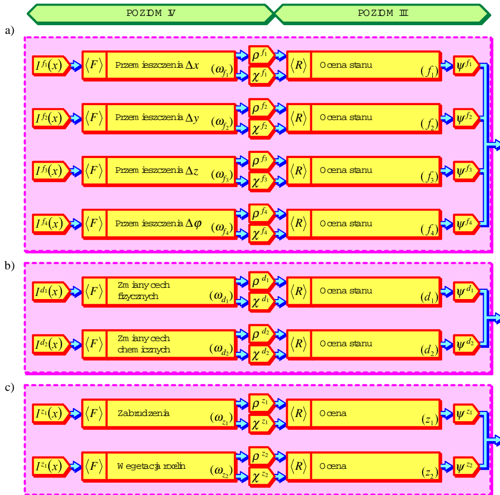
Rys. 6.18. Schematy funkcjonalne wybranych modułów sieci hybrydowej BBS1 z rys. 6.17: a) moduł „F”, b) moduł „D”, c) moduł „Z”
