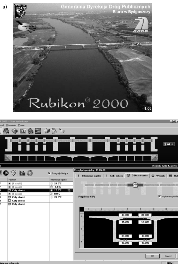
Rys. 1.29. System RUBIKON [31]: a) ekran tytułowy, b) monitorowanie odkształceń konstrukcji mostu
