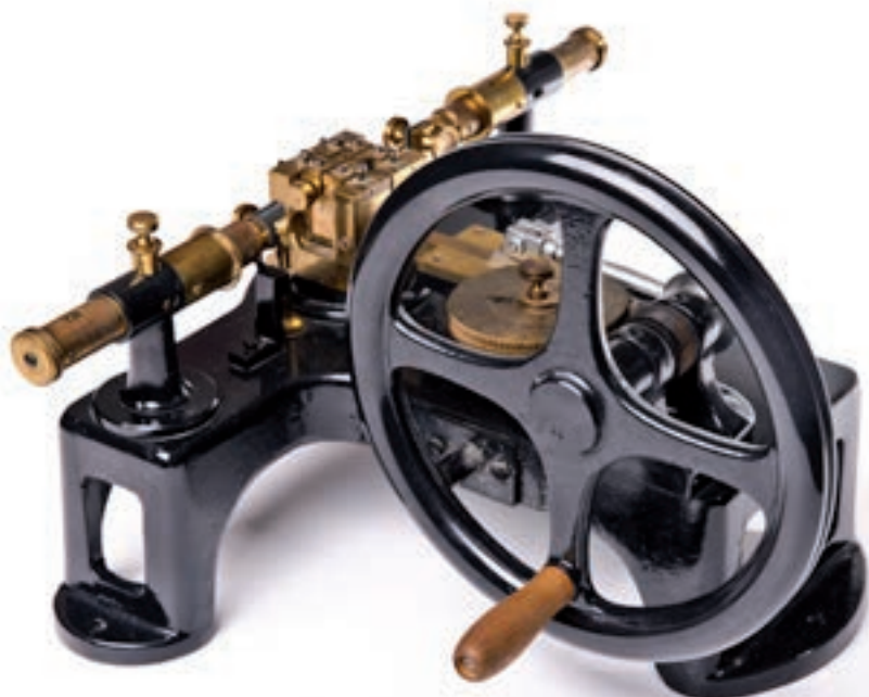
Urządzenie do badania odporności na podwójne zgięcia z ok. 1920 r. (zbiory Muzeum Papiernictwa, sygn. MD 49 T)
