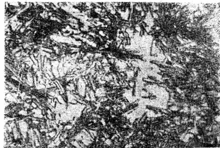
Rys. 23. Węgiel wolframu odlewany 4% C. Widoczne: W_2C ciemny, WC jasny Trawiony elektrolitycznie NaOH \times 1400
