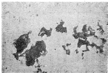
Rys. 2. Skupienie porów i pory szkieletowe Zgląd nietrawiony \times 1400
