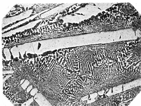
Rys. 14. Przekrój 80 % Co, 12 % P, chłodzone w piecu, trawione rozcieńczonym \text{HNO}_3 ; pierwotnie: (\text{Co, Fe})_2\text{P} (jasne); eutektyka; \alpha (ciemne) + (\text{Co, Fe})_2\text{P} \times 370
