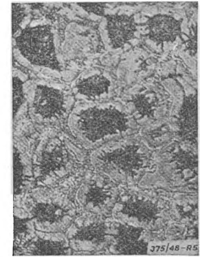
Rys. 6. Stal szybko tnąca 18% W hartowana z 1350° w oleju (x 800).
