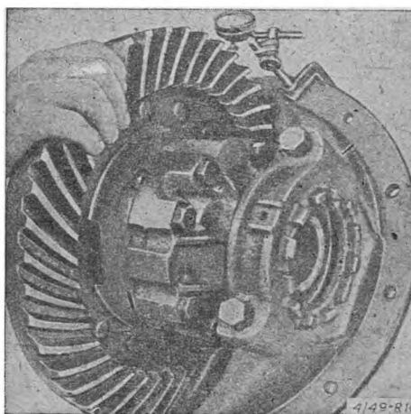
Rys. 10. Sprawdzanie luzu międzyzębnego kół przekładni napędowej.
