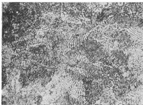
Rys. 2. Struktura stali do wyrobu drutu fortepianowego.
