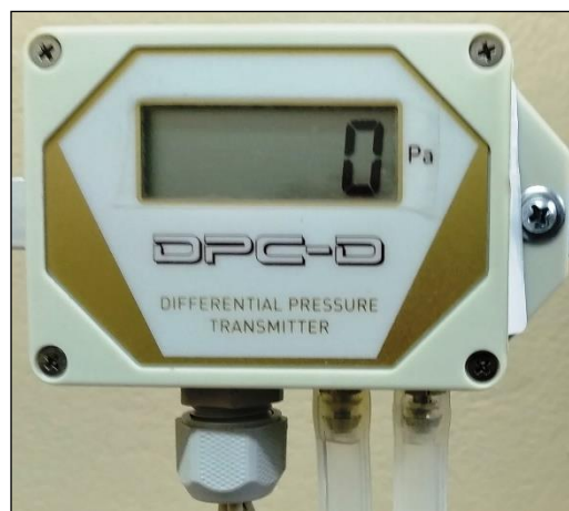
Rys. 5.13. Widok jednego z przetworników różnicy ciśnień wchodzącego w skład układu do pomiaru oporów przepływu
