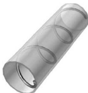
Rys. 2.28. Spiralnie zwinięty drut turbulizujący przepływ w rurze, wg [48]
