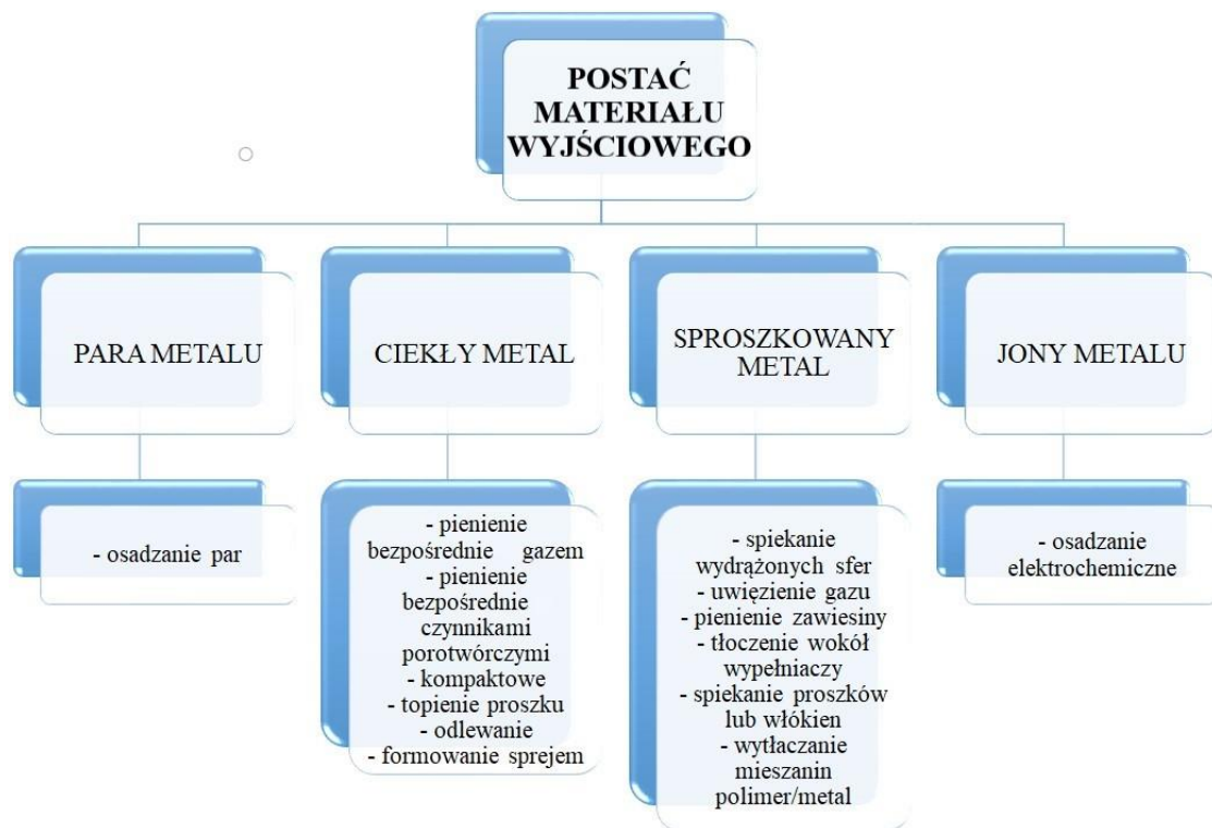
Rys. 3.1. Podział metod wytwarzania pian metalowych, wg [54]
