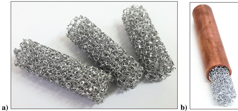
Rys. 5.10. Walcove elementy przygotowanej do montażu piany metalowej a) oraz poglądowy widok piany wypełniającej rurę b)
