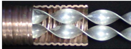
Rys. 2.27. Dwie skręcone taśmy umieszczone w spiralnie ożebrowanej rurze, wg [43]
