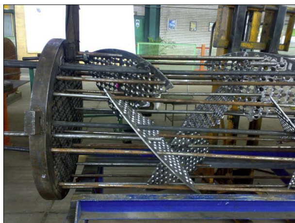
Rys. 2.9. Konstrukcja wymiennika ciepła z przegradami helikalnymi wg [24]
