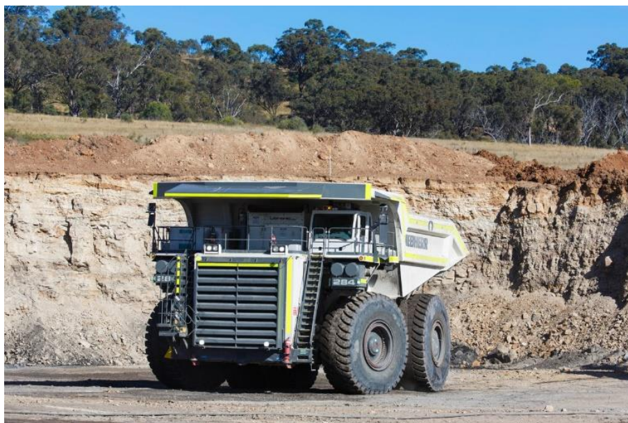
Rysunek 1. Ciężki pojazd transportowy Liebherr T284 [7]
