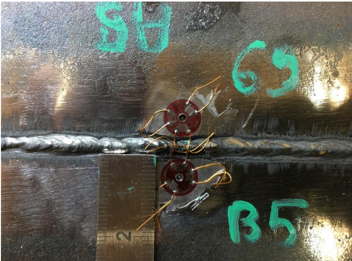
Rysunek 55. Wywiercone otwory pomiarowe przez rozetę tensometryczną
