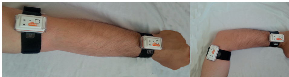
Rys. 13.10. Umocowanie czujników na ramieniu i przedramieniu [238]
