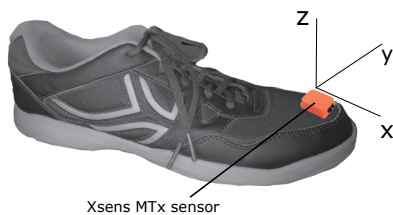
Rys. 4.5. Sposób przymocowania czujnika przyśpieszenia (przykład z podrozdz. 4.2.4)
