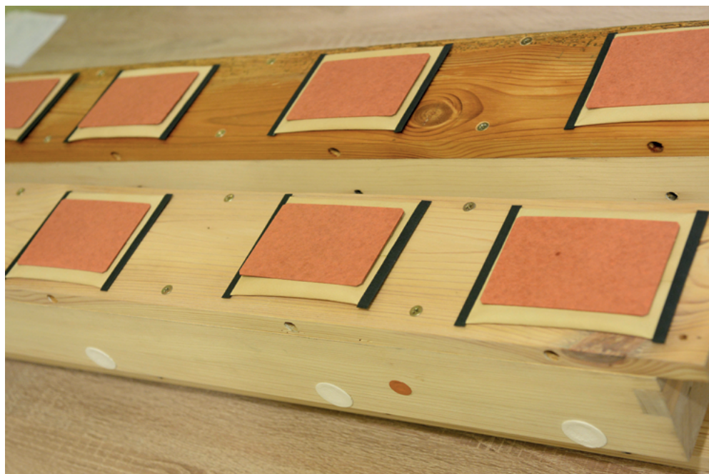
Fotografia 7. Odrestaurowana wiatrownica rejestrowa z membranami wielkoformatowymi. Powierzchnia górna wiatrownicy powyżej impregnowana żywicą syntetyczną. Organy kościoła ewangelickiego w Drogomyślu. Fot. T. Orłow
