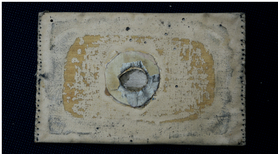
Fotografia 5. Membrana rejestrowa wykonana z niewłaściwego materiału. Na powierzchni widoczne ślady aktywności owadów drzewnych. Organy kościoła ewangelickiego w Drogomyślu. Fot. T. Orłow
