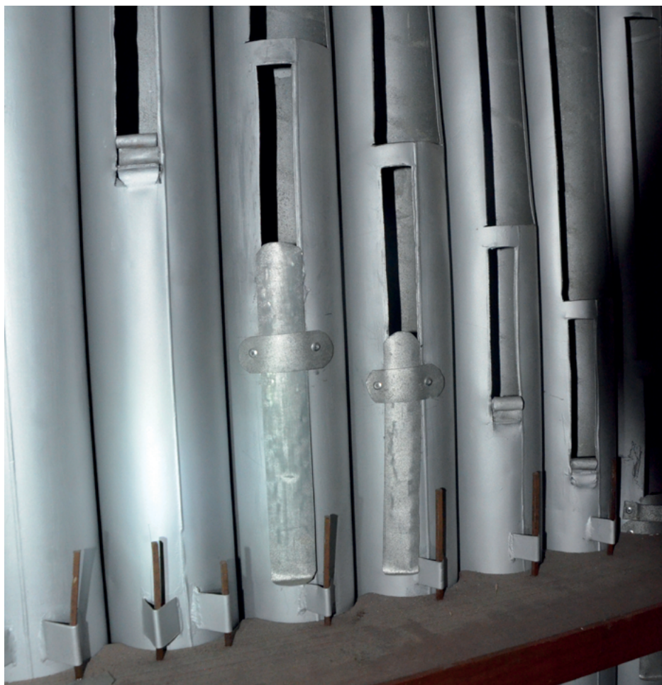
Fotografia 19. Piszczałki prospektowe głosu Prinzipal 8'. Widok na nitowane uchwyty stroików. Stan przed konserwacją. Organy kościoła pw. Najświętszego Serca Pana Jezusa w Rogowie. Fot. T. Orłow
