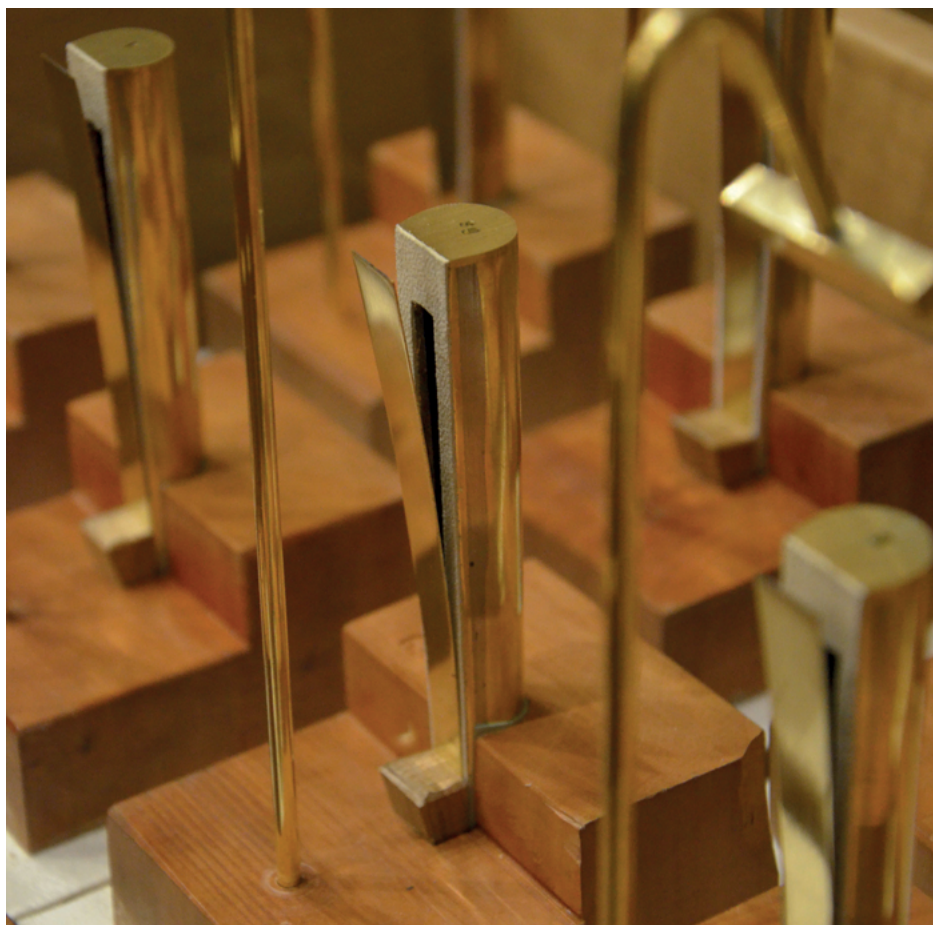
Fotografia 21. Piszczalki głosu językowego Posaune 16'. Stan po konserwacji. Widoczne nowe okleiny skórzanym rynienek. Organy firmy Walker w kościele pw. Najświętszej Marii Panny Królowej Polski w Pogórze. Fot. T. Orłow
