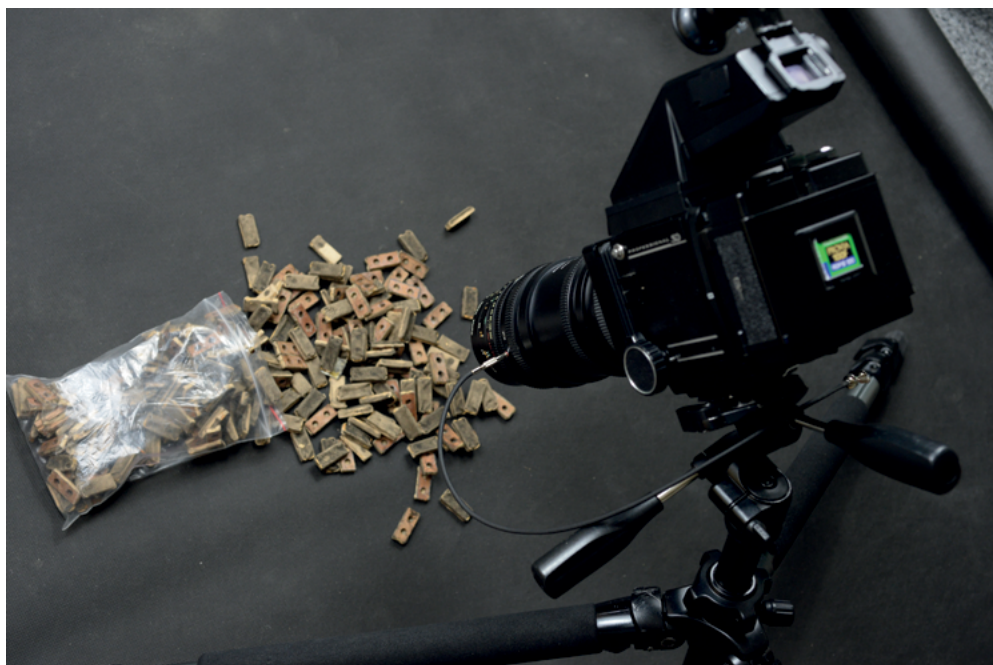
Fotografia 1. Analogowa makrofotografia średnioformatowa. Dokumentacja membran przelotowych traktury pneumatycznej stołu gry 1 . Fot. T. Orłow
