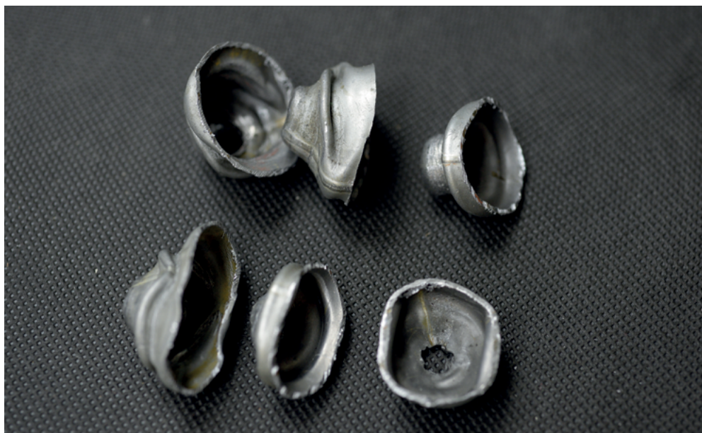
Fotografia 17. Odcięte dolne części nóg piszczałkowych wykonanych z blachy cynowo-oluwianej. Widoczne sfalcowania blachy i zniekształcenia geometrii piszczałki. Fot. T. Orłow
