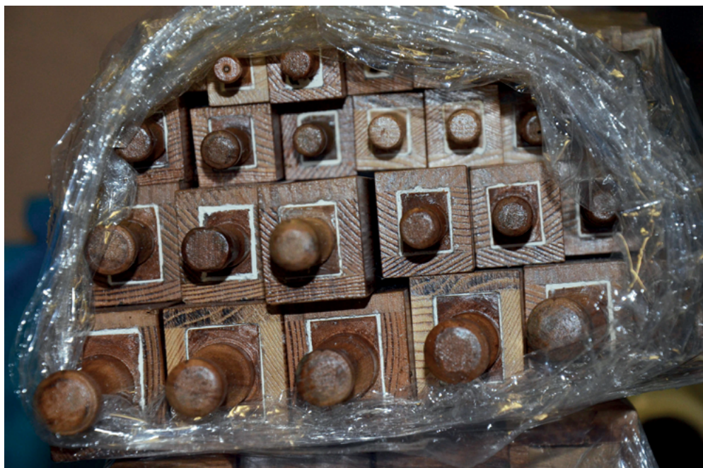
Fotografia 16. Odrestaurowane piszczałki głosu krytego Gedackt 8'. Widoczne uszczelnienia skórane dopasowane pod względem wymaganej grubości. Rejestr dyszkantowy, organy firmy Neusser w kaplicy pw. Świętej Rodziny w Cieszynie. Fot. T. Orłow
