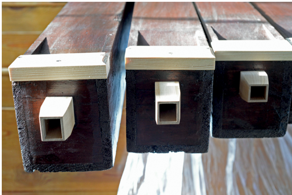
Fotografia 4. Zrekonstruowane elementy dźwiękotwórcze piszczałek głosu Violon 16'. Organy kościoła ewangelickiego w Drogomyślu. Fot. T. Orłow
