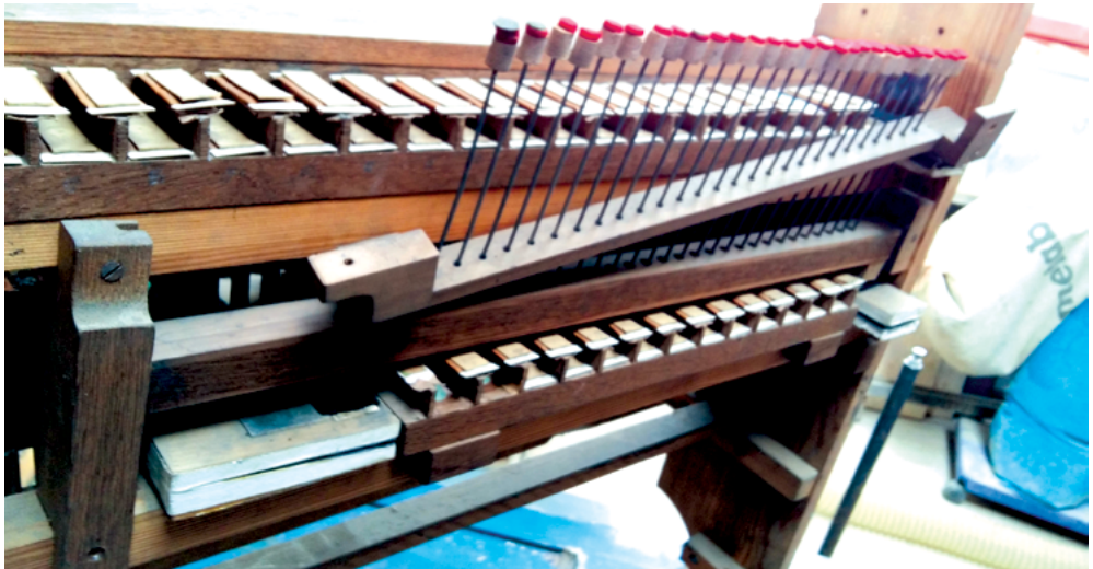
Fotografia 26. Organy w Nieparcie – mechanizm połączenia manualu II z pedalem. Fot. T. Sowiński
