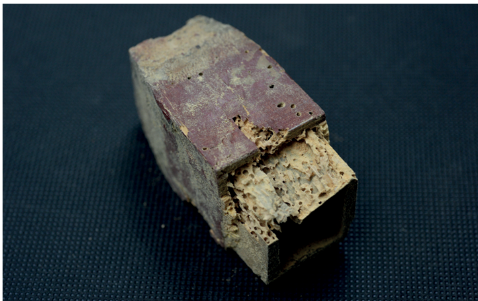
Fotografia 2. Noga piszczałkowa głosu Violon 16' zniszczona na skutek destrukcji biologicznej. Organy kościoła ewangelickiego w Drogomysłu. Fot. T. Orłow
