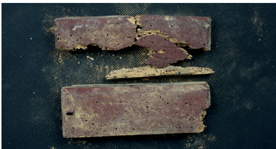
Fotografia 3. Wargi dolne piszczałek głosu Violon 16' w stanie rozpadu zniszczone na skutek destrukcji biologicznej. Organy kościoła ewangelickiego w Drogomysłu. Fot. T. Orłow
