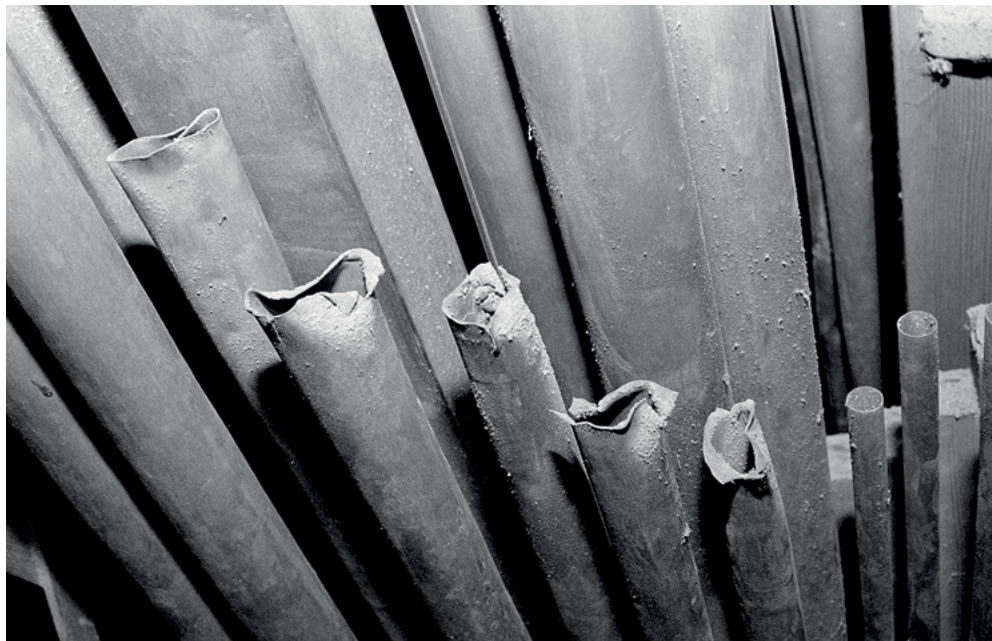
Fotografia 18. Rozerwane korpusy metalowych piszczałek głosu Octav 2'. Organy kościoła pw. św. Doroty w Trzcinicy. Fot. T. Orłow
