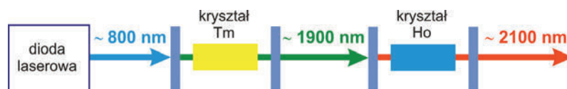
Rys. 16. Ideowy schemat lasera holmowego pompowanego wiązką lasera tulowego Fig. 16. Schematic diagram of a holmium doped laser pumped by a thulium doped laser
