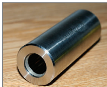
Rys. 22. Zdjęcie kondensatora wykorzystanego w układzie laboratoryjnym mikroskopu na zakres „okna wodnego” Fig. 22. A photograph of the “water window” condenser used for SXR microscope
