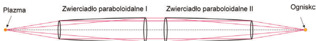
Rys. 10. Schemat ogniskowania promieniowania plazmy laserowej z zastosowaniem kolektora paraboloidalnego
