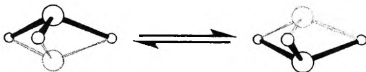
Rys. 18. Inwersja cząsteczki amoniaku. Za układ odniesienia przyjęto płaszczyznę atomów H. W rzeczywistości inwersja zachodzi względem środka masy
