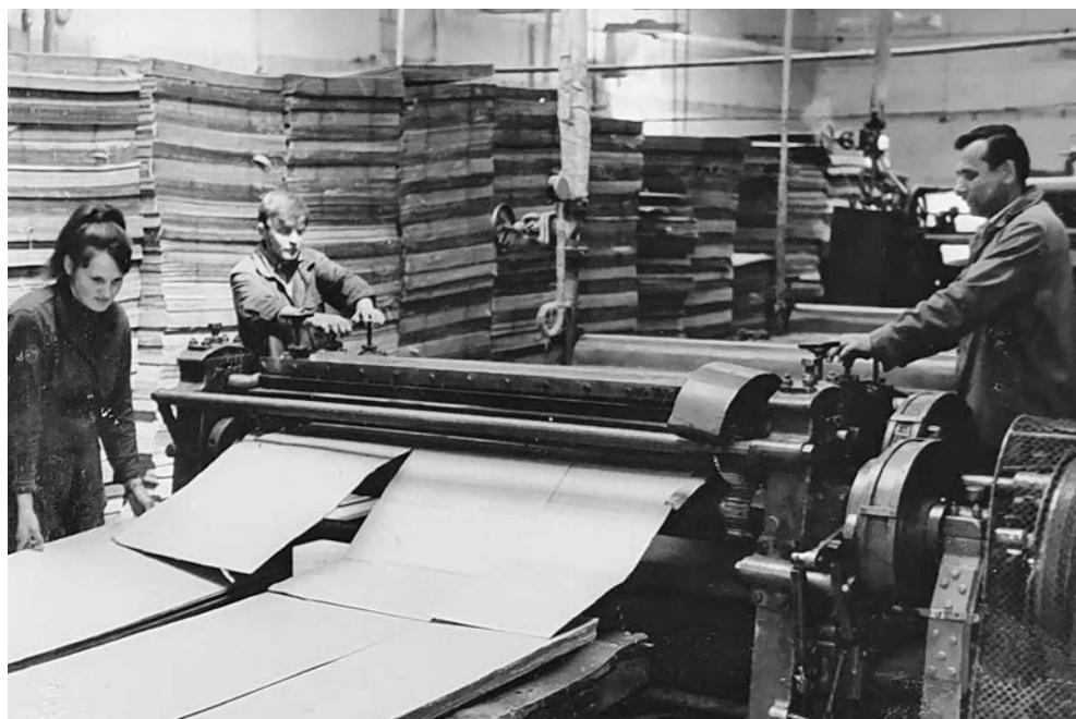
2. Produkcja tektury na starej tekturnicy w BZWP. Fot. z lat 60. XX wieku, źródło: Kronika Bystrzyckich Zakładów WYROBÓW PAPIEROWYCH , w zbiorach Mondi BZWP Sp. z o.o.
