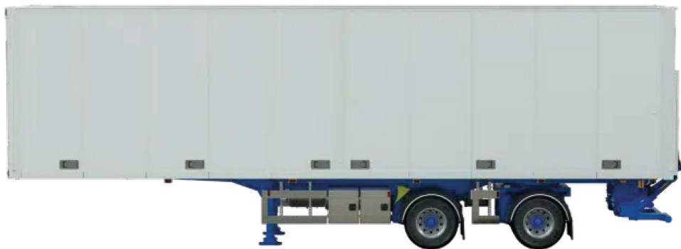
Rys. 6. Fińska miejska 2-osiowa naczepa dystrybucyjna Ekeri Oy z systemem drzwi bocznych
