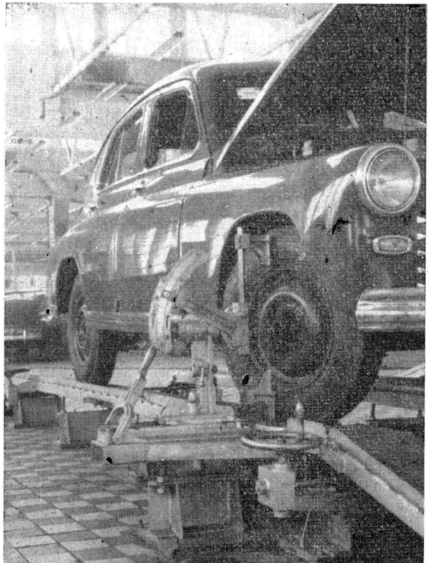
Rys. 5. Pomiar kąta wyprzedzenia — \gamma przy skręcie kół w lewo na 20^\circ
