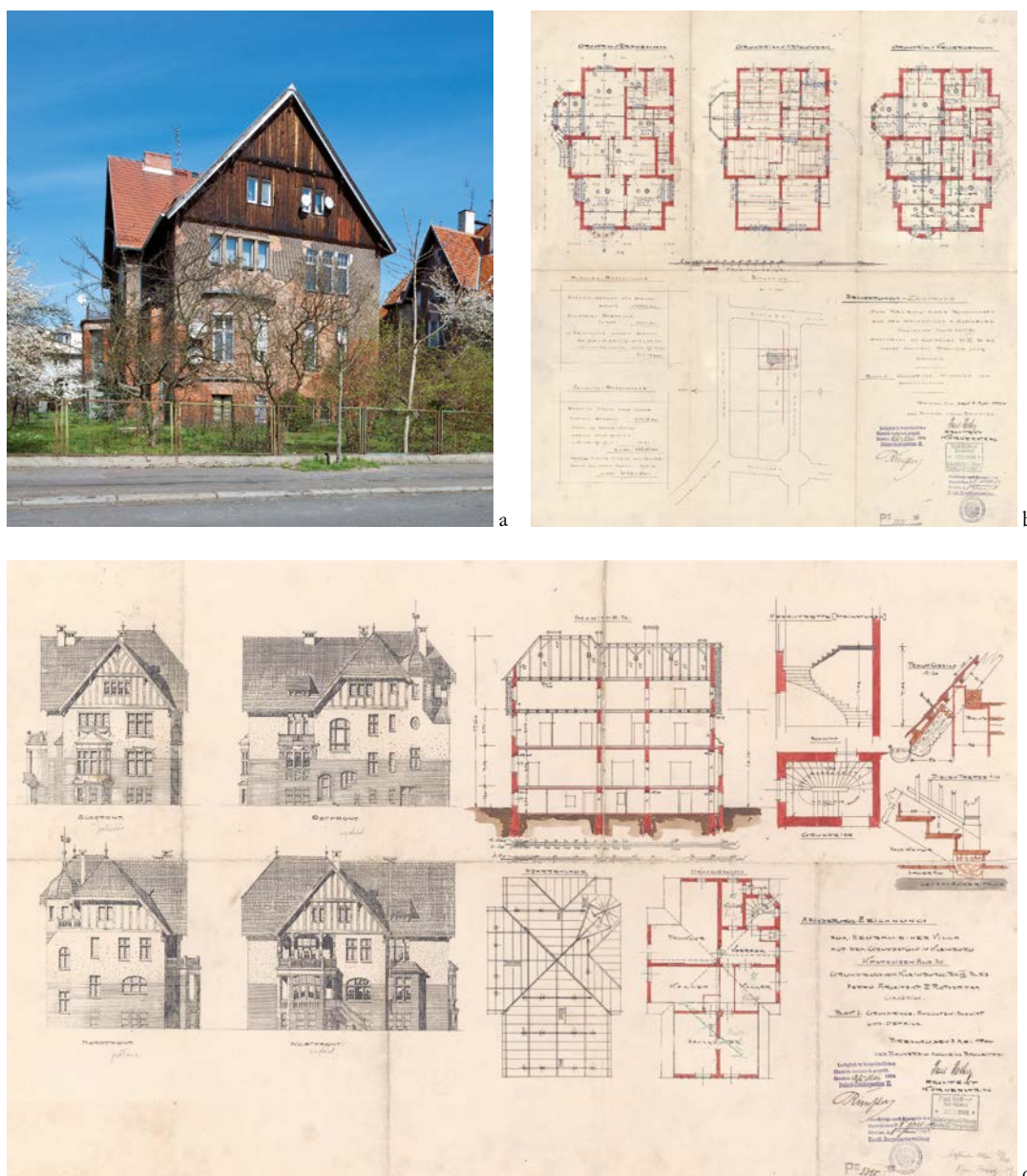
Il. 62. Wrocław, al. Kasztanowa 28, a) widok willi od strony frontowej (fot. S. Klimek); korekta projektu willi, 1904: b) plan sytuacyjny, rzuty (MA/ABMW, t. 2183, sygn. MAT-AB-94370), c) elewacje, przekrój, rzut dachu, detale (MA/ABMW, t. 2183, sygn. MAT-AB-94369).
