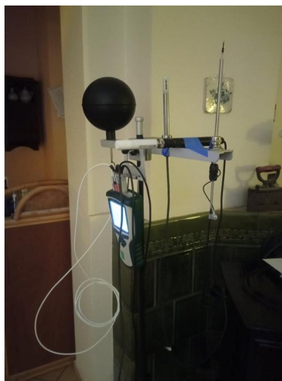
Zdjęcie 12 Stanowiska do pomiaru parametrów mikroklimatu (kolekcja autorki)
