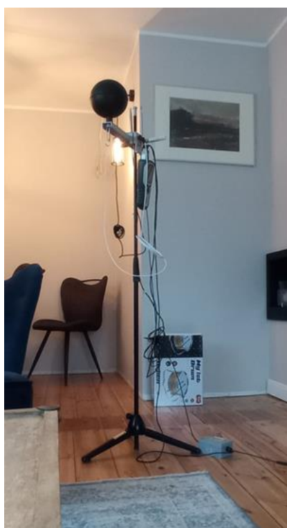
Zdjęcie 12 Stanowiska do pomiaru parametrów mikroklimatu (kolekcja autorki)
