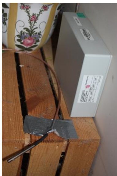
Zdjęcie 9 Przykładowe elementy stanowiska badawczego: rejestrator, czujnik temperatury oraz wilgotności względnej (kolekcja autorki)
