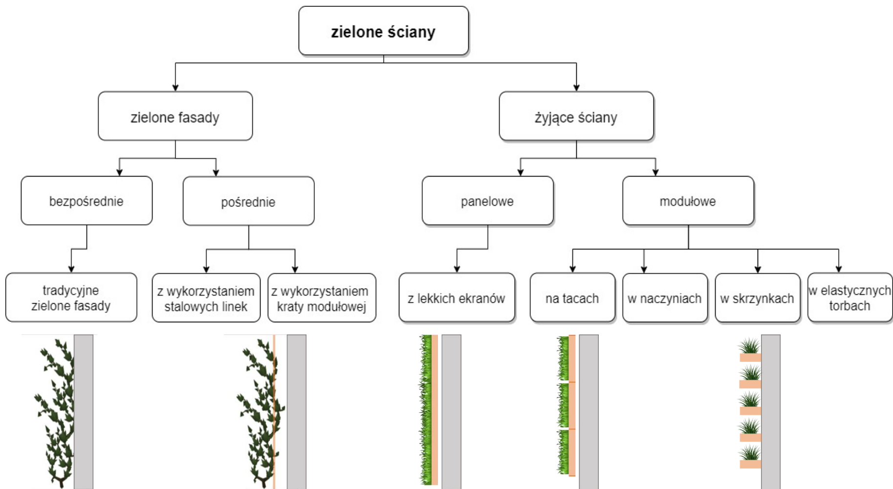
Rysunek 1 Klasyfikacja zielonych ścian (opracowane i tłumaczenie własne na podstawie [28,30])
