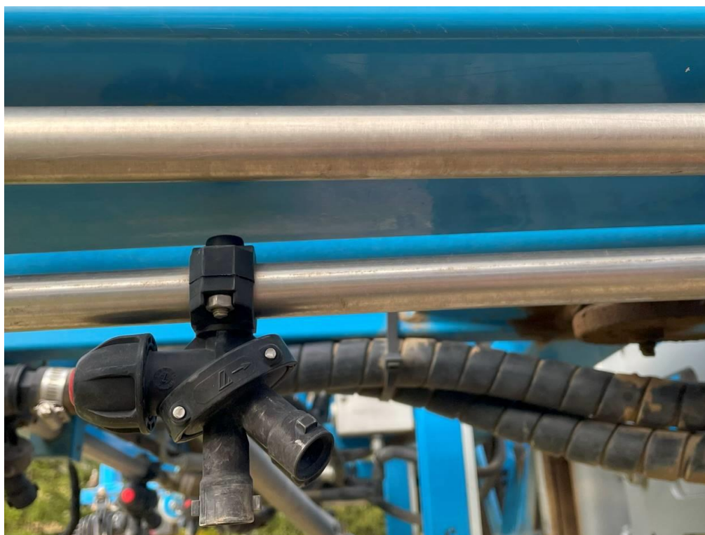
Rys. 6. Rury ze stali nierdzewnej wykorzystywane w opryskiwaczu rolniczym.
