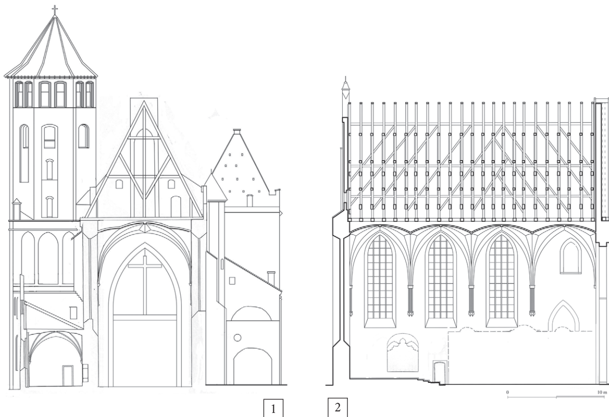
134. Aktualizacja inwentaryzacji prezbiterium według [ACD, 1], stan z 2004 r.: 1 – przekrój poprzeczny, 2 – ściana południowa (oprac. ZWA PWr)
