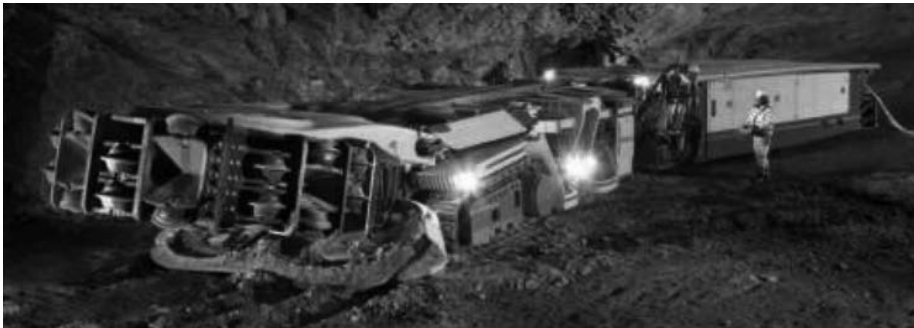
Rysunek 6 Kombajn firmy Epiroc Mobile Miner 22H w kopalni platyny w RPA urabiający dyskami symetrycznymi
