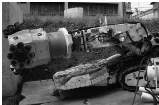
Rysunek 3 Widok głowicy z narzędziami dyskowymi zabudowanej na ramieniu kombajnu KR 150
