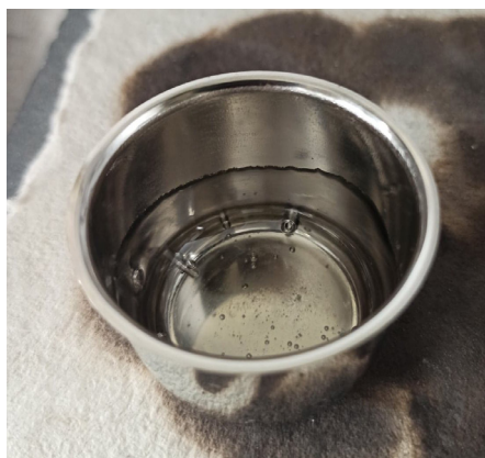
Rycina 4. Ścianki ochronne wykonane ze stopionego LiT.
