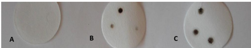
Rysunek 12. Przykładowe próbki pobrane ze spalin samojezdnych maszyn górniczych pracujących w podziemnych wyrobiskach górniczych. A – filtr pobrany z maszyny, w której silnik pracował w sposób prawidłowy; B, C – filtry pobrane z maszyn, których silniki uległy awarii.
