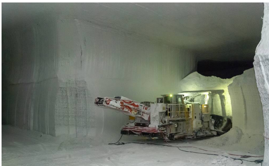
Rysunek 3. Przykład wykonania drugiej warstwy wyrobiska (z trzech) przez kombajn MB770. Każdy z przebiegów kombajnu tworzy wyrobisko o szerokości 7,5 m i wysokości 5 m. Na zdjęciu widać łącznie cztery przebiegi kombajnu, co daje wyrobisko o przekroju poprzecznym równym 15 m szerokości i 10 m wysokości.
