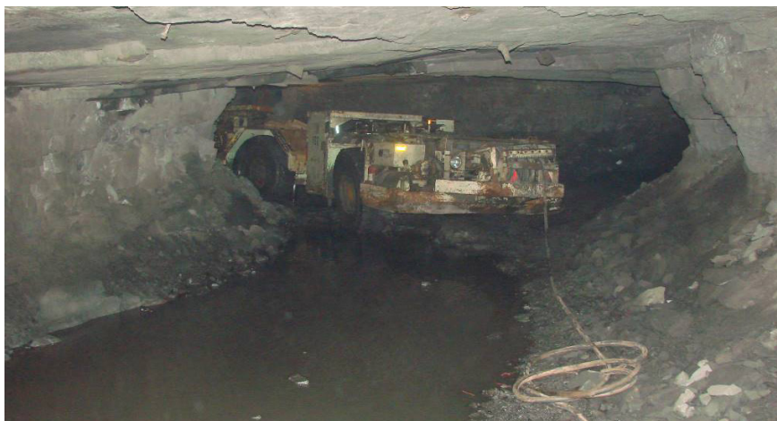
Rysunek 2. Przykładowe wyrobisko miedziowe. Na szczególną uwagę zasługują nieregularne kształty ociosów i stropu wyrobiska, co w konsekwencji powoduje zaburzenie przepływu powietrza.
