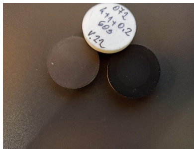
Rycina 2. Próbkki materiałów krzemowych przygotowane w postaci pastylek.
