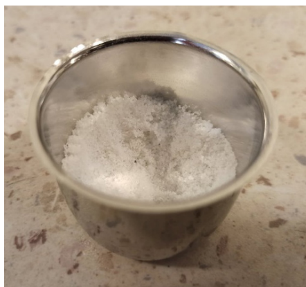
Rycina 5. Topnik wraz z tlenkiem boru umieszczone w tyglu platynowym
