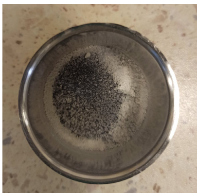
Rycina 3. Próbkę mikrokrzemionki przygotowana do stapiania.
