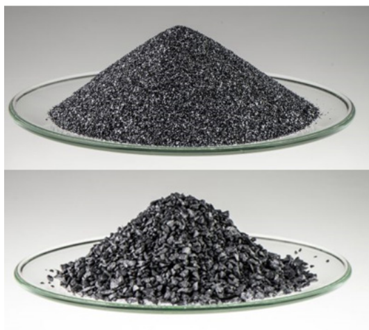
Rycina 1. Krzem metaliczny i FSM – zdjęcie materiałów przeznaczonych na CRM w ramach projektu SilRef.
