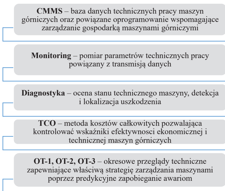
Rysunek 1. Schemat powiązań monitoringu z działaniami zmierzającymi do właściwego określenia stanu technicznego maszyny górniczej.
