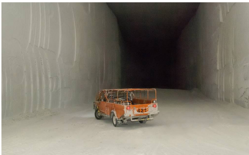
Rysunek 8. Widok wyrobiska wykonanego kombajnem MB770 poprzez wykonanie łącznie sześciu przebiegów kombajnu. Wyrobisko w przekroju poprzecznym jest zbliżone do kwadratu z bokiem o długości 15 m. Dla porównania pojazd znajdujący się na pierwszym planie ma wysokość 2,1 m.
