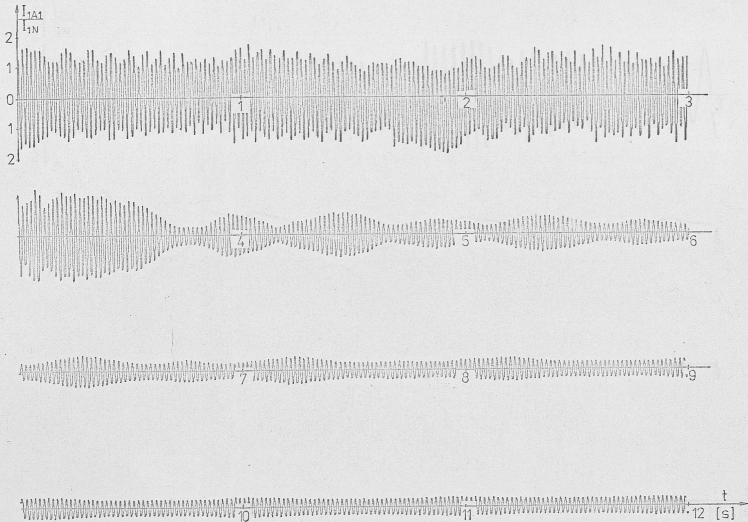
Rys.VI.17. Przebieg prądu stojana podczas niesymetrycznego rozruchu dla przenośnika nieobciążonego (faza A, silnik A)
