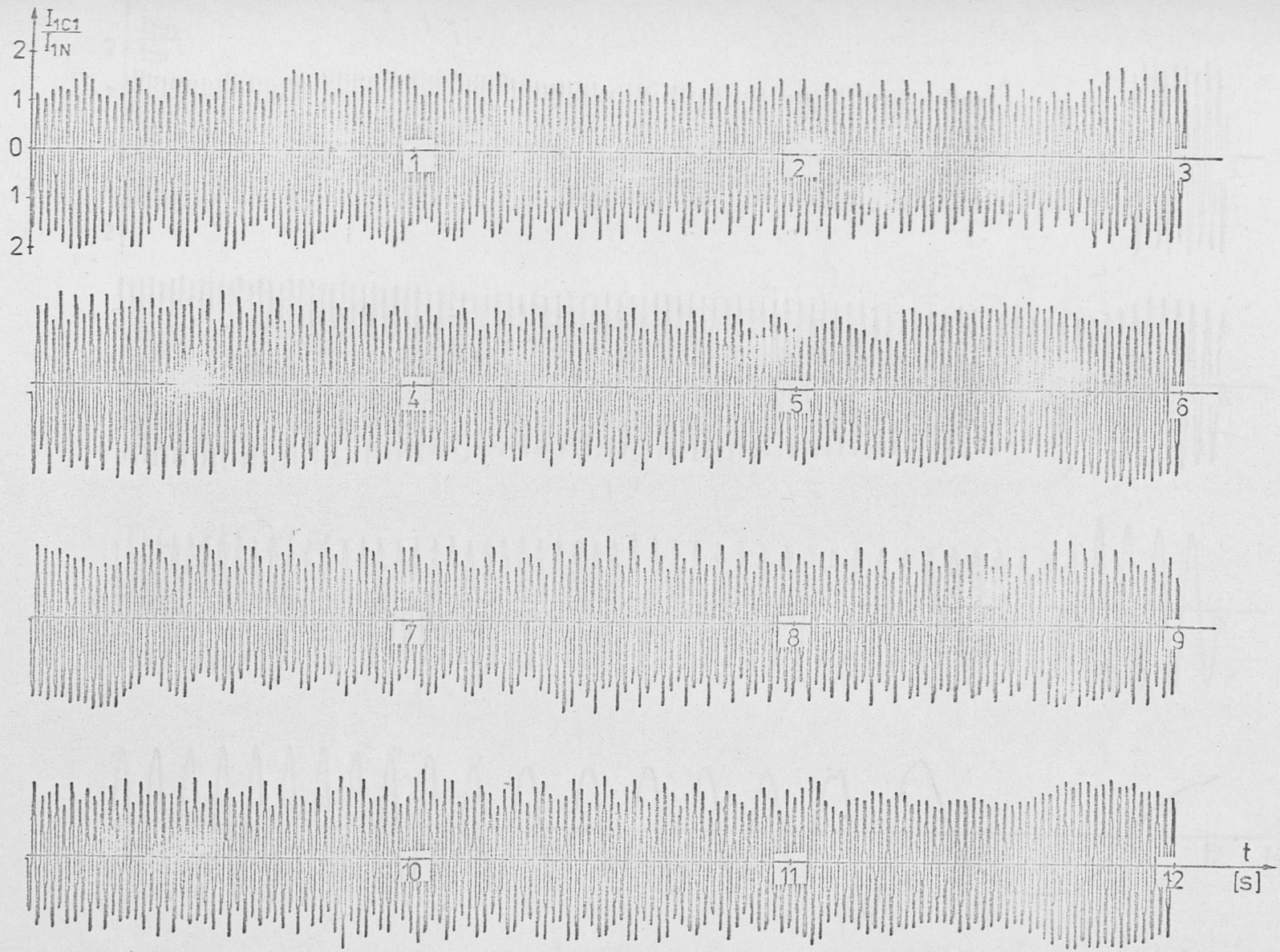
Rys.VI.2. Przebieg prądu stojana podczas niesymetrycznego rozruchu dla przenośnika obciążonego (faza C, silnik A)
