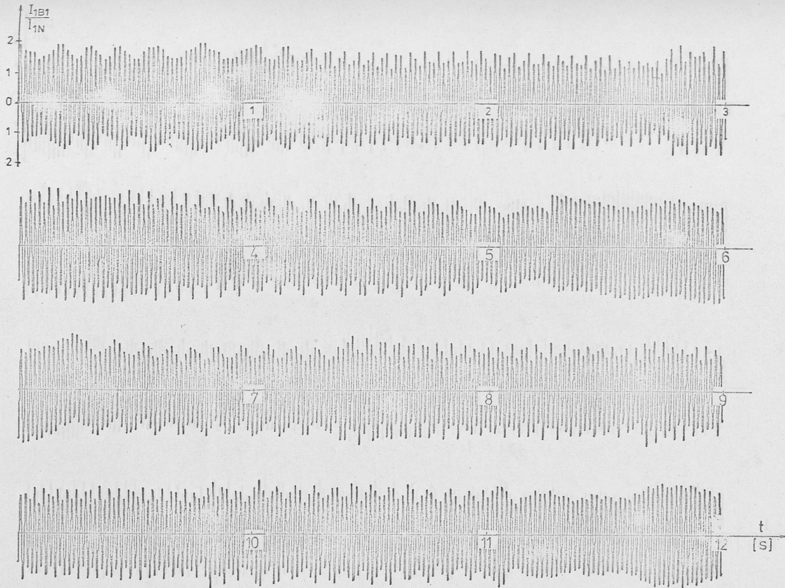
Rys.VI.1. Przebieg prądu stojana podczas niesymetrycznego rozruchu dla przenióska obciążonego (faza B, silnik A)
