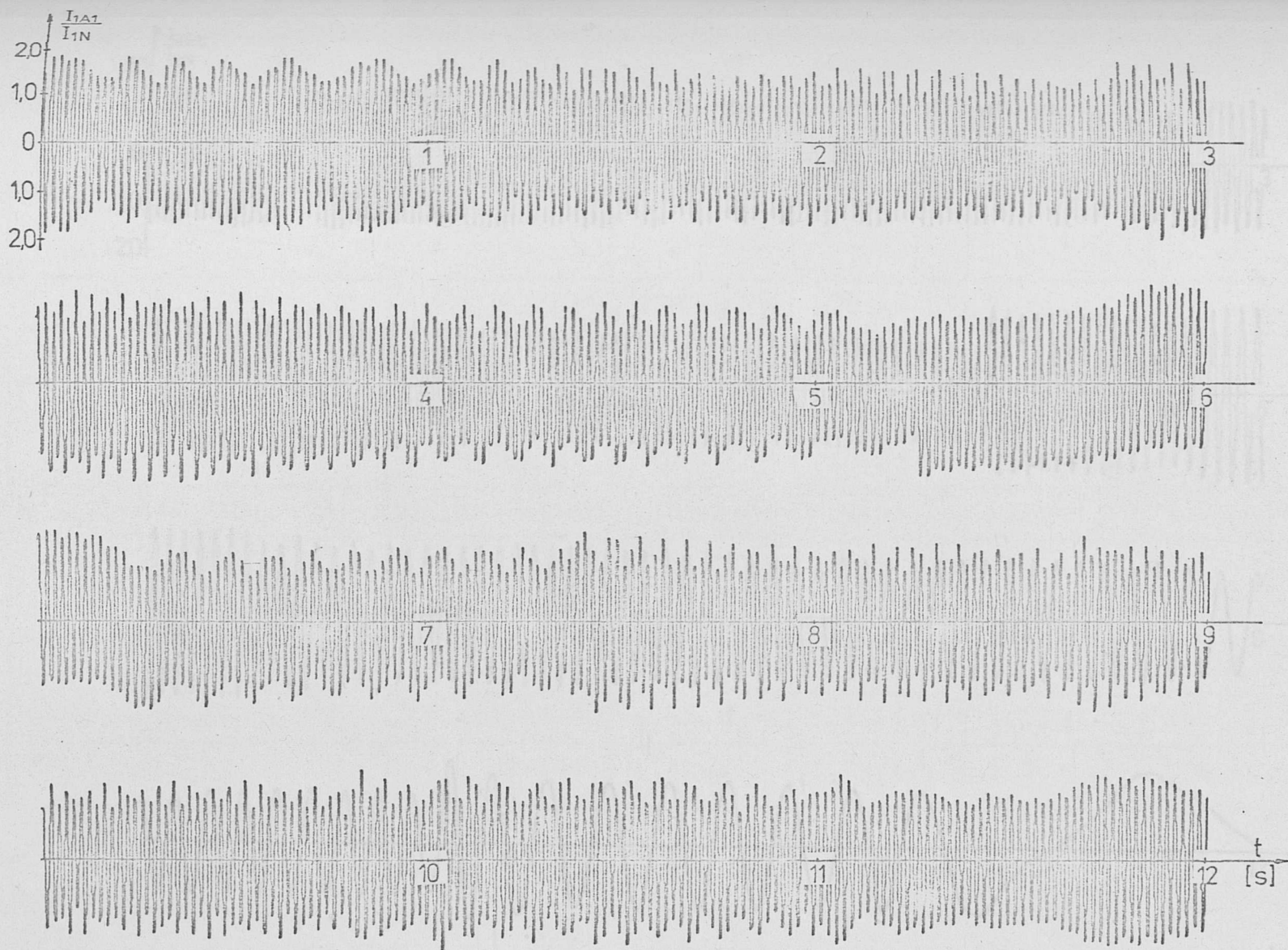
Rys.10.2. Przebieg prądu stojana podczas niesymetrycznego rozruchu dla prze- nośnika obciążonego (faza A, silnik A)
