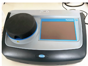
Rys. 3.3. Mętnościomierz laserowy TU5200
