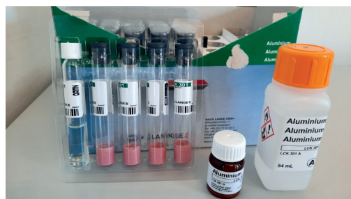
Rys. 3.7. Test do oznaczania glinu: kuwety i odczynniki (a) oraz opis procedury (b)
