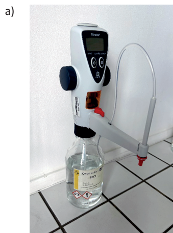
Rys. 3.2. Biureta cyfrowa Titrette Brand (a) i szklana (b)
