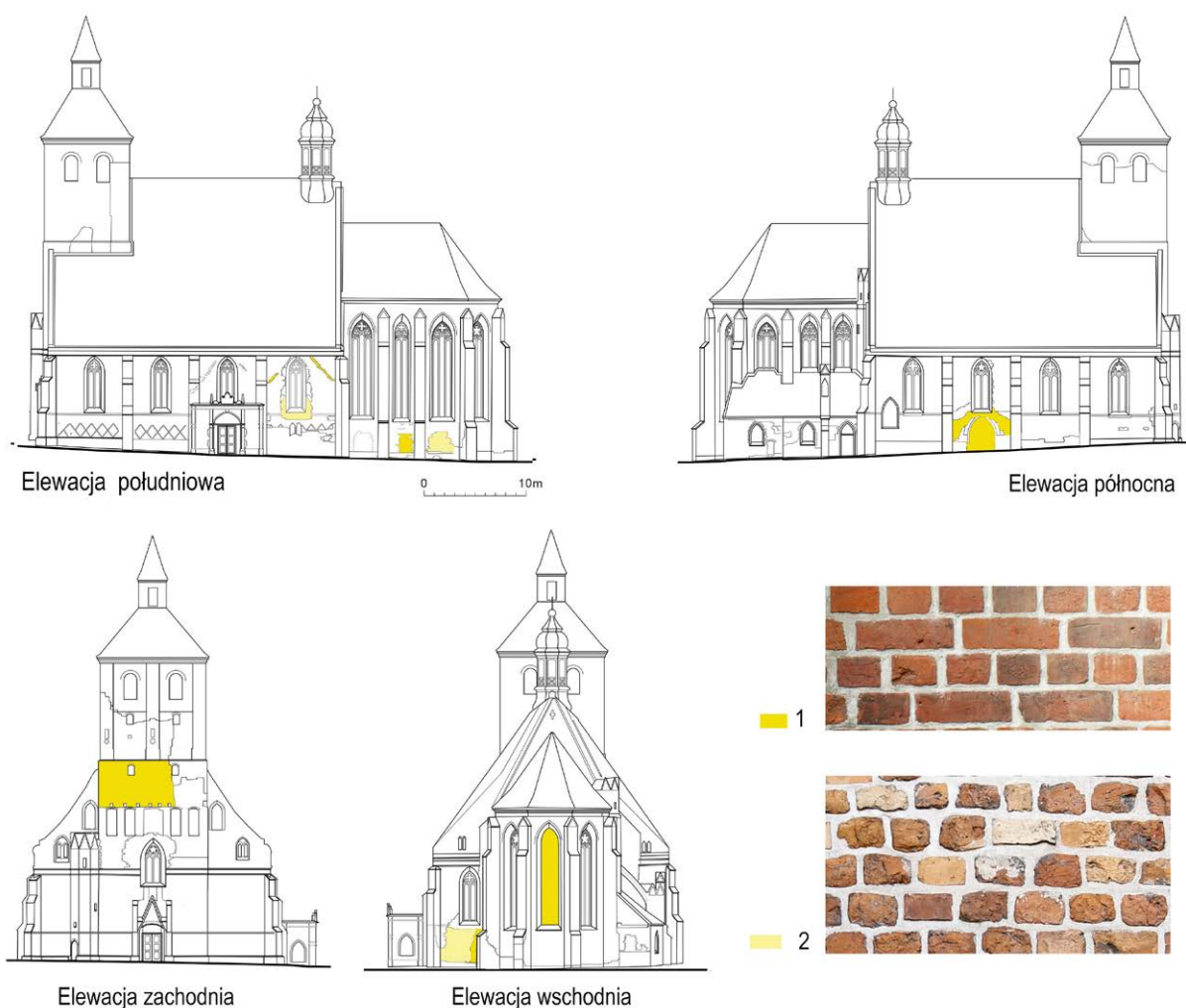
Il. 15. Miejsca występowania warstwy budowlanej AJS 5 i AJS 6, schematy inwentaryzacyjne. Układy cegieł: 1 – blokowy AJS 5, 2 – główkowy AJS 6; fot. i oprac. E.Ł., F.H.
