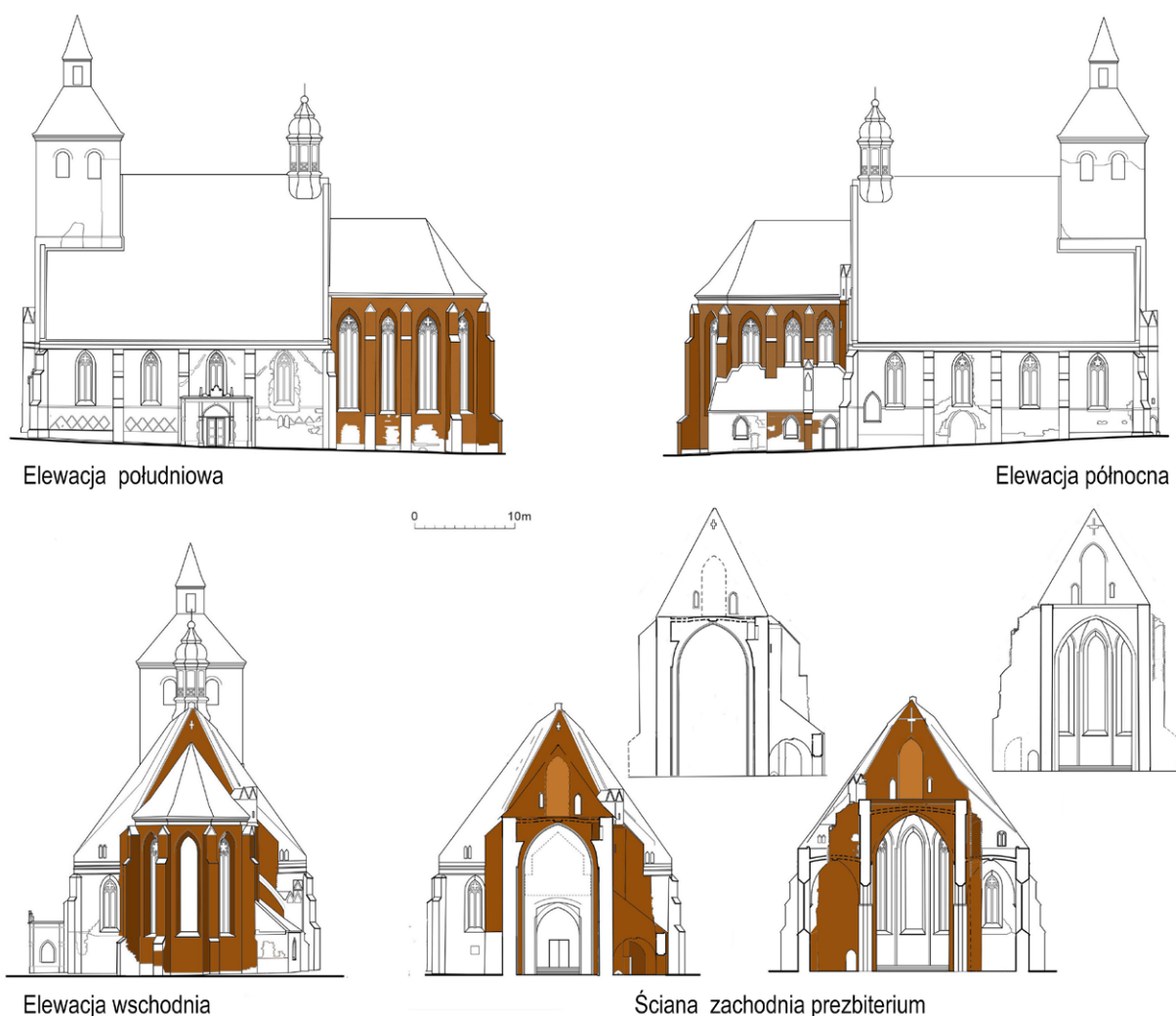
Il. 5. Zasięg występowania warstwy budowlanej AJS 1, schematy inwentaryzacyjne; oprac. E.Ł., F.H.
