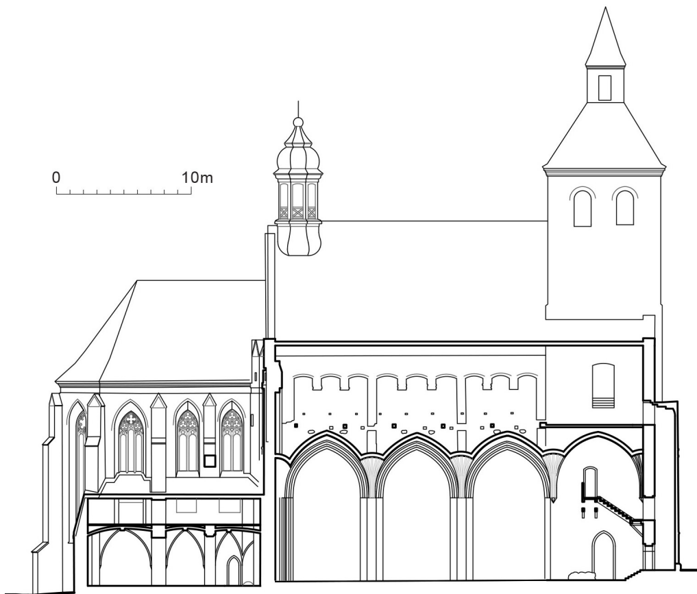
Il. 100. Kościół św. Mikołaja – strych nad nawą północną (2023), przekrój B-B; oprac. F.H.
