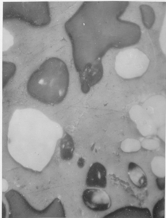
Rys.71 Koks z witrytu węgla gazowo-koksowego z kop. Dębieńsko
