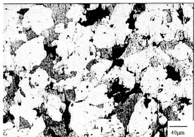
Rys. 5.1.15. Struktura mosiądzu CuZn38,9Pb2,5 odkształconego do \varepsilon = 0,7 w temperaturze 473 K z \dot{\varepsilon} = 0,1 \text{ s}^{-1}
