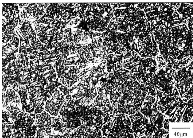
Rys. 5.2.27. Struktura od- kształconego brązu aluminio- wego CuAl10,3Fe2,8Mn2 w temperaturze 1023 K do \varepsilon = 60 z \dot{\varepsilon} = 0,01 \text{ s}^{-1} Fig. 5.2.27. Structure of CuAl10,3Fe2,8Mn2 aluminium bronze deformed to \varepsilon = 60 at 1023 K with \dot{\varepsilon} = 0.01 \text{ s}^{-1}
