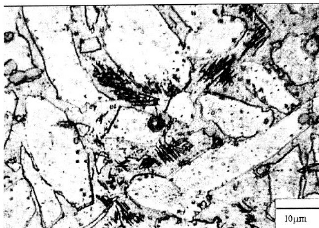
Rys. 5.2.25. Struktura nieodkształconego brązu aluminio- wego CuAl10,3Fe2,8Mn2 po oziębieniu z temperatury 773 K Fig. 5.2.25. Structure of non- deformed CuAl10,3Fe2,8Mn2 aluminium bronze after co- oling from 773 K
