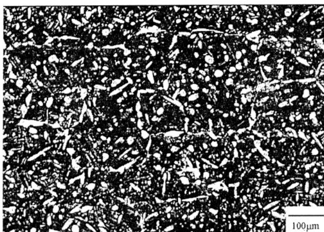
Rys. 5.2.26. Struktura nieod- kształconego brązu aluminio- wego CuAl10,3Fe2,8Mn2 po oziębieniu z temperatury 1023 K Fig. 5.2.26. Structure of non- deformed CuAl10,3Fe2,8Mn2 aluminium bronze after co- oling from 1023 K
