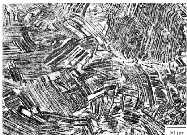
Rys. 5.3.22. Struktura brązu CuSi5,2 po odkształceniu \varepsilon = 0,3 w temperaturze 573 K z \dot{\varepsilon} = 0,01 \text{ s}^{-1} [81]
