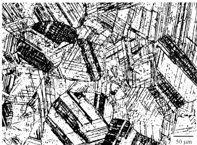
Rys. 5.3.16. Struktura brązu krzemowego CuSi 4,6 odkształconego w temperaturze 973 K do \varepsilon = 7,3 z \dot{\varepsilon} = 0,6 \text{ s}^{-1} [81]
