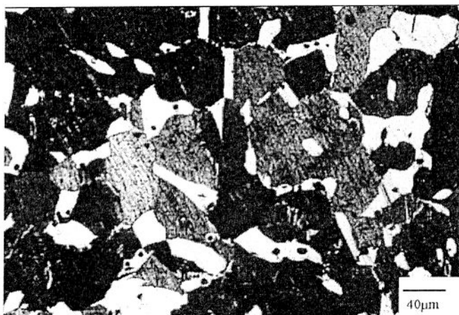
Rys. 5.1.17. Struktura mosiądzu CuZn38,9Pb2,5 nieodkształconego, oziębionego z temperatury 973 K
