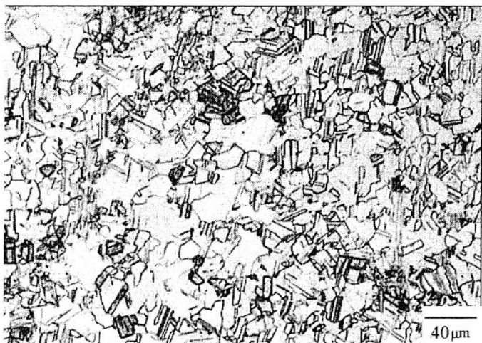
Rys. 5.3.6. Struktura brązu krzemowego CuSi 3,9 odkształconego w temperaturze 923 K do \varepsilon = 3 z \dot{\varepsilon} = 0,01 \text{ s}^{-1}
