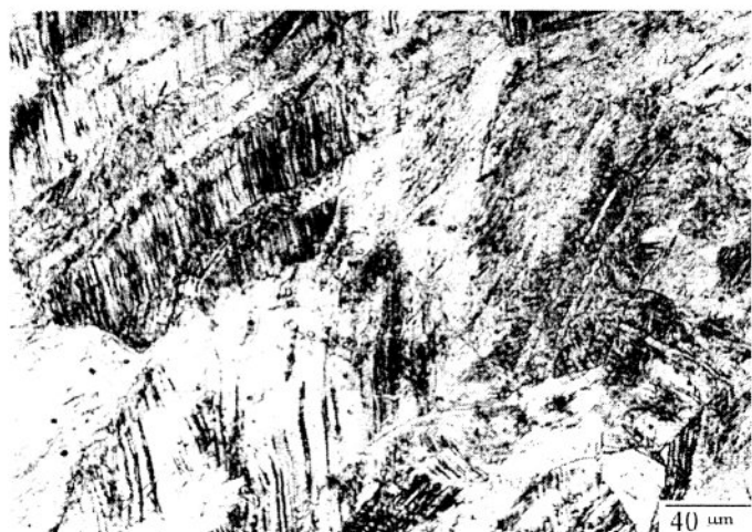
Rys. 5.3.4. Struktura brązu krzemowego CuSi 3,9 odkształconego w temperaturze 293 K do \epsilon = 1,23 z \dot{\epsilon} = 0,01 \text{ s}^{-1} [81]
