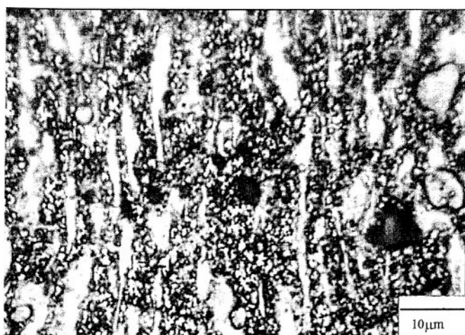
Rys. 5.2.24. Struktura odkształconego brązu aluminiumowego CuAl10,3Fe2,8Mn2 w temperaturze 773 K do \varepsilon = 5 z \dot{\varepsilon} = 0,01 \text{ s}^{-1} Fig. 5.2.24. Structure of CuAl10,3Fe2,8Mn2 aluminium bronze deformed to \varepsilon = 5 at 773 K with \dot{\varepsilon} = 0.01 \text{ s}^{-1}
