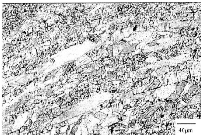
Rys. 5.2.4. Struktura brązu aluminiumowego CuAl8,1Fe2,9 odkształconego w temperaturze 923 K do \epsilon = 0,7 z \dot{\epsilon} = 0,01 \text{ s}^{-1}
