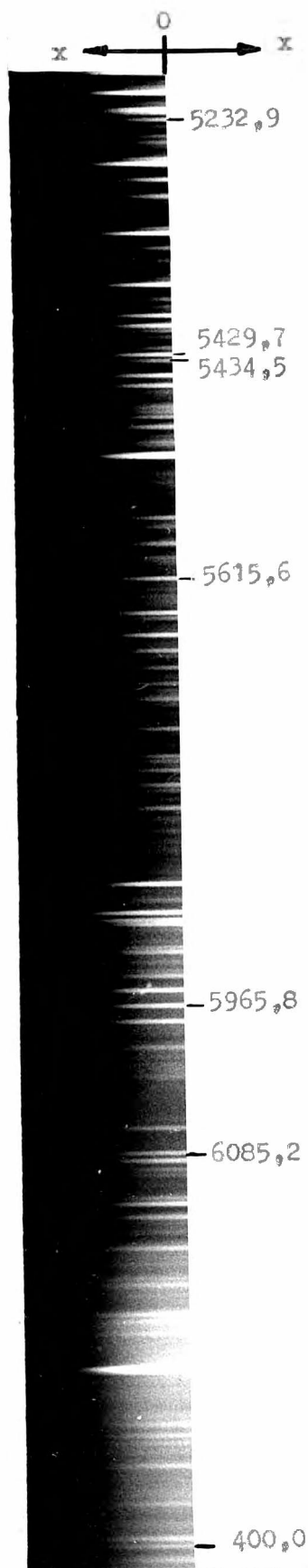
Rys. 23. Wycinek ze spektrogramu przekroju strumienia plazmy (zdjęcie 1).
